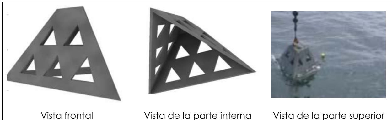
Figura 6. Esquema y fotografía de las diversas caras de la estructura piramidal del AMA.
