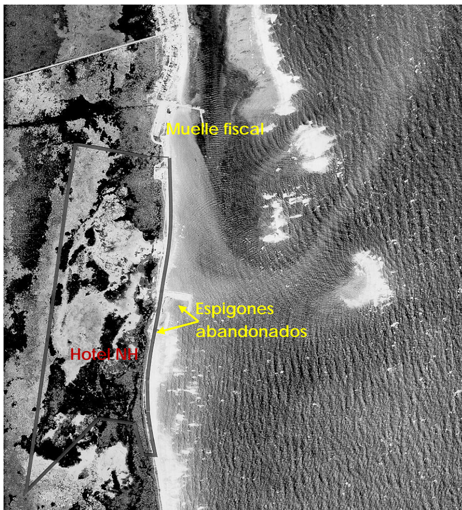
Figura 23. Se observa el espigón norte y sur de lo que se tenía planeado como puerto pesquero. (Fotografía aérea INEGI).
